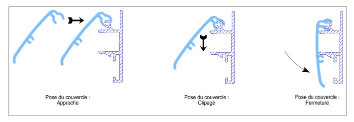
• Les rails Cimex+ ont la particularité de posséder un couvercle articulé amovible ; cette fonction permet d'effectuer la pose des rails sans couvercles. De cette façon aucune rayure ou salissure de chantier ne se fera pendant la pose. Cette particularité permet aussi d'opérer un changement de couleur du couvercle sans dépose du rail lui même.
