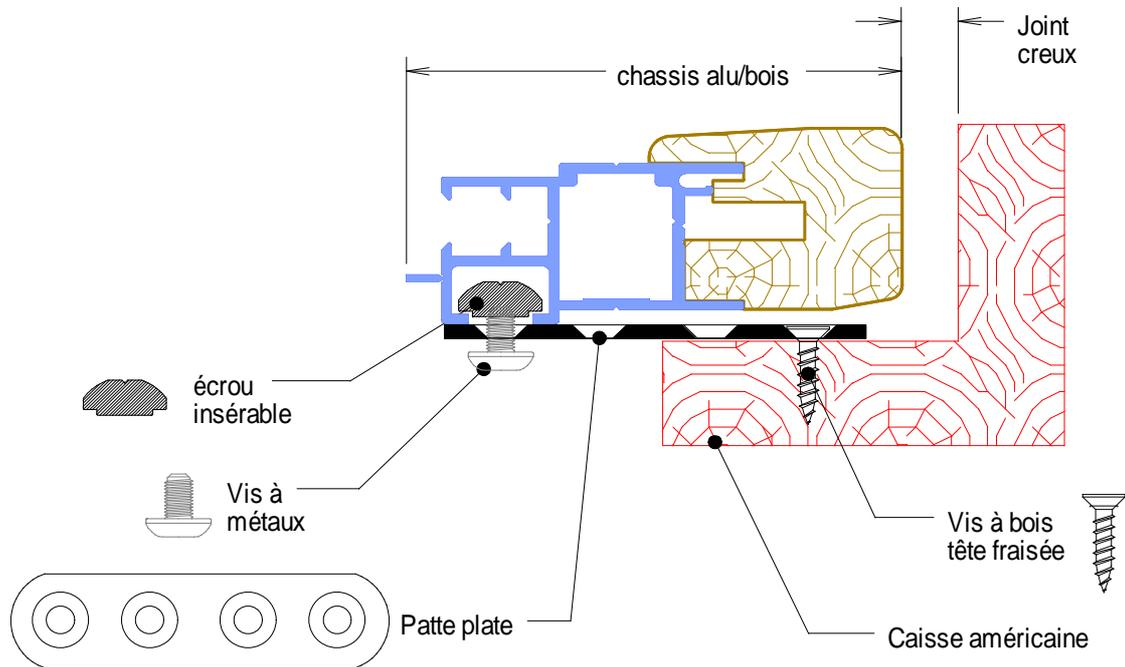
La solution retenue est de relier le châssis au cadre par l'intermédiaire de pattes plates en acier (en vente partout).
