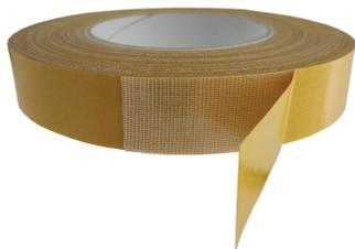
Le ruban adhésif double face différentiel RDF305 se compose d'une toile coton enduite d'un adhésif synthétique clair à base de caoutchouc (collage permanent côté Tyvek) sur la face ouverte et d'un adhésif clair à base d'émulsion acrylique (collage repositionnable côté objet) sur la face protégée. Au déroulage, la face adhésive visible est la face **permanente**, la face restant protégée étant la face **repositionnable**.
