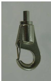
**Modèle OPER-S** avec bague de sécurité permettant de verrouiller le coulissement vertical, pour câbles de  $\varnothing$  1 à 1,8 mm.
