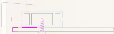
Pose d'un panneau de protection arrière amovible. Fixation par vissage ou ruban auto-agrippant
