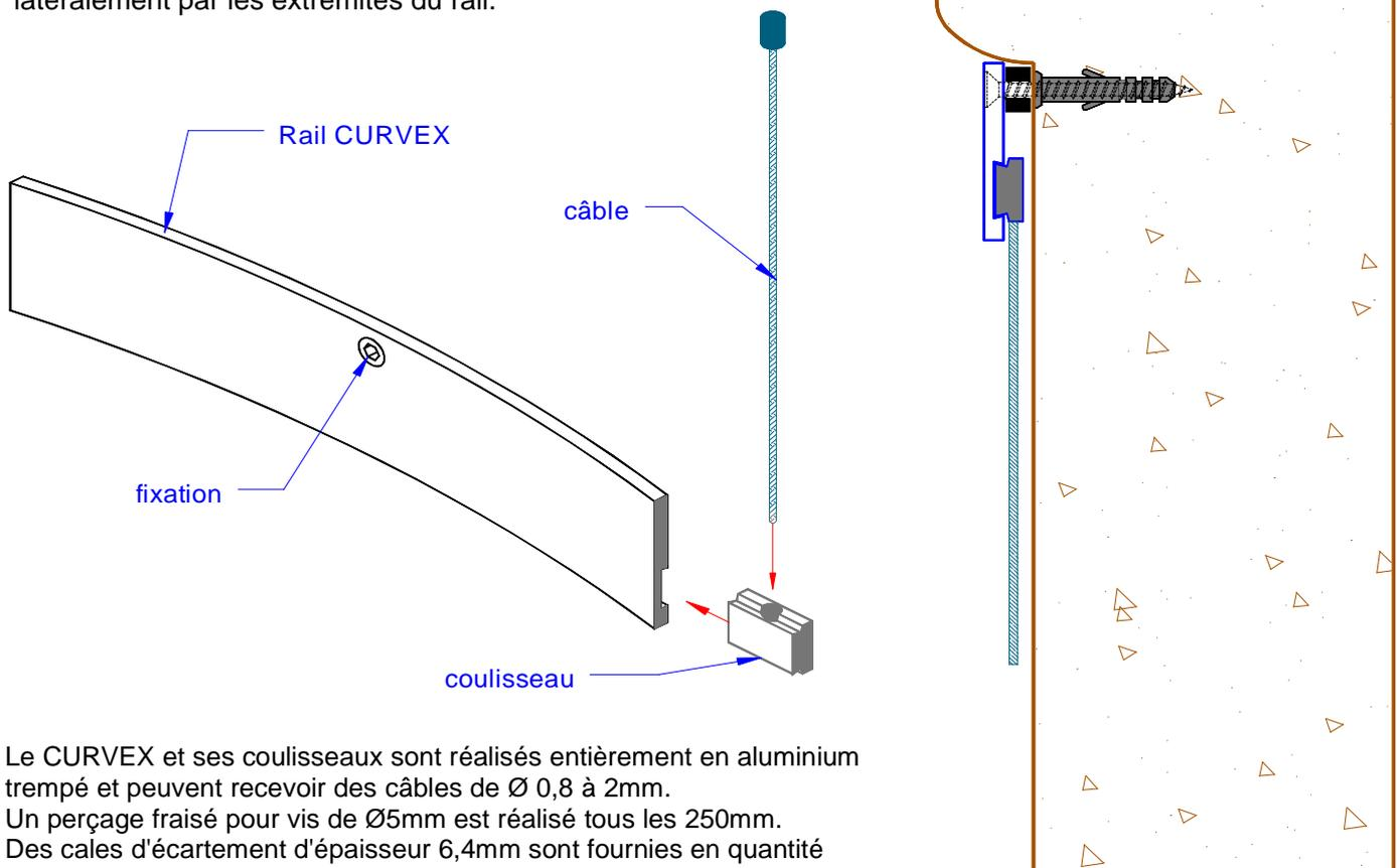
Le CURVEX et ses coulisseaux sont réalisés entièrement en aluminium trempé et peuvent recevoir des câbles de  $\varnothing$  0,8 à 2mm. Un perçage fraisé pour vis de  $\varnothing$ 5mm est réalisé tous les 250mm. Des cales d'écartement d'épaisseur 6,4mm sont fournies en quantité correspondant au nombre de trous. Charge maxi conseillée 35kg par câble avec maxi de 60kg/m.
