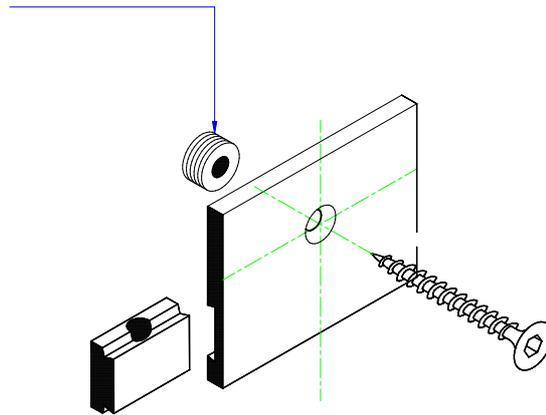
1. Repérer très précisément l'emplacement des percages muraux de chevilles en se servant du rail comme gabarit. Un pointage des trous de cheville à travers le rail (foret au carbure de  $\text{\O}5\text{mm}$ ) est conseillé.
