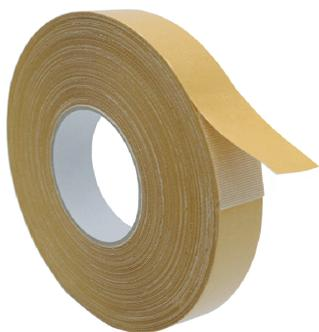
Le ruban adhésif double face différentiel RDF734 se compose d'une toile coton enduite d'un adhésif clair à base de caoutchouc synthétique de type élastomère, avec une adhésion plus forte sur la face protégée (collage permanent côté Tyvek) et moins forte sur la face ouverte (collage repositionnable côté objet).
