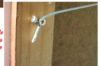
*Couper une longueur de câble et la bloquer dans un des Stoppers avec le même tournevis*
