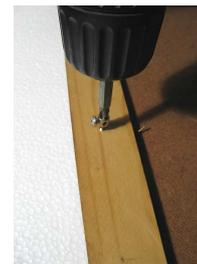
*Visser 2 Stoppers de part et d'autre du tableau avec un tournevis ou une visseuse cruciforme*
