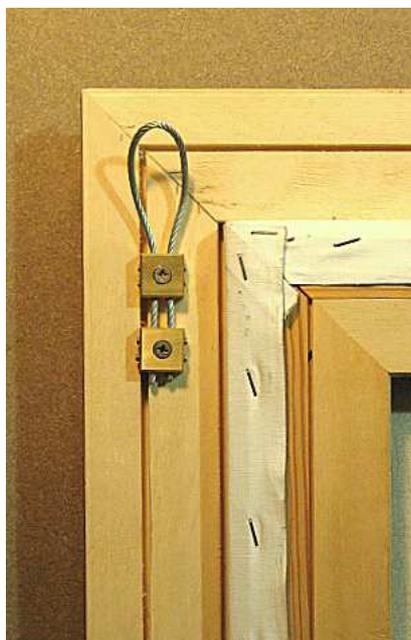
Les câbles utilisés seront des câbles souples Inox type 7×19. Le câble sort des Unix, passe à travers le crochet mural et revient dans les Unix où il est bloqué par les 2 vis de serrage. Une sécurité antivol renforcée sera obtenue en utilisant des vis de serrage à empreinte de sûreté ou en sertissant un manchon à l'extrémité du câble.
