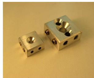
Les 4 vis de blocage sont des vis sans tête en acier inoxydable. Des vis avec empreinte de sécurité permettent de rendre le dispositif antivol (option). Le nombre des **Unix** utilisés pour chaque attache sera déterminé en fonction de la charge à supporter et de la tenue des vis dans le bois de l'œuvre ou du cadre sur lequel les attaches sont fixées.
